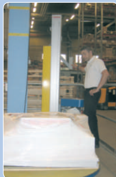
▶ Varje pall fixeras noga med sträckfilm
